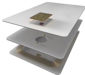
Figura 4.3 Imagen interior de una TUI
