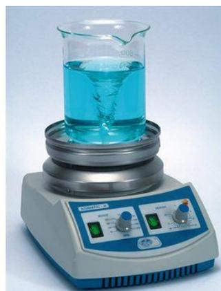
**Figura 3.2.1.2. Agitador magnético.**
