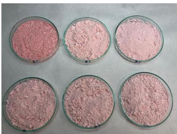
**Figura 4.3.5.1. Polvo obtenido mediante el BÜCHI B-290.
