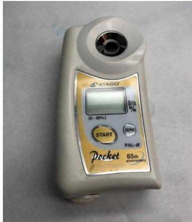
**Figura 3.2.2.1 Refractómetro de mano.**
