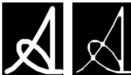
Figura 4: Ejemplo de la utilización Erode de OpenCV.
