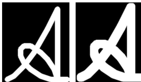
Figura 6: Ejemplo de la utilización Dilate de OpenCV.
