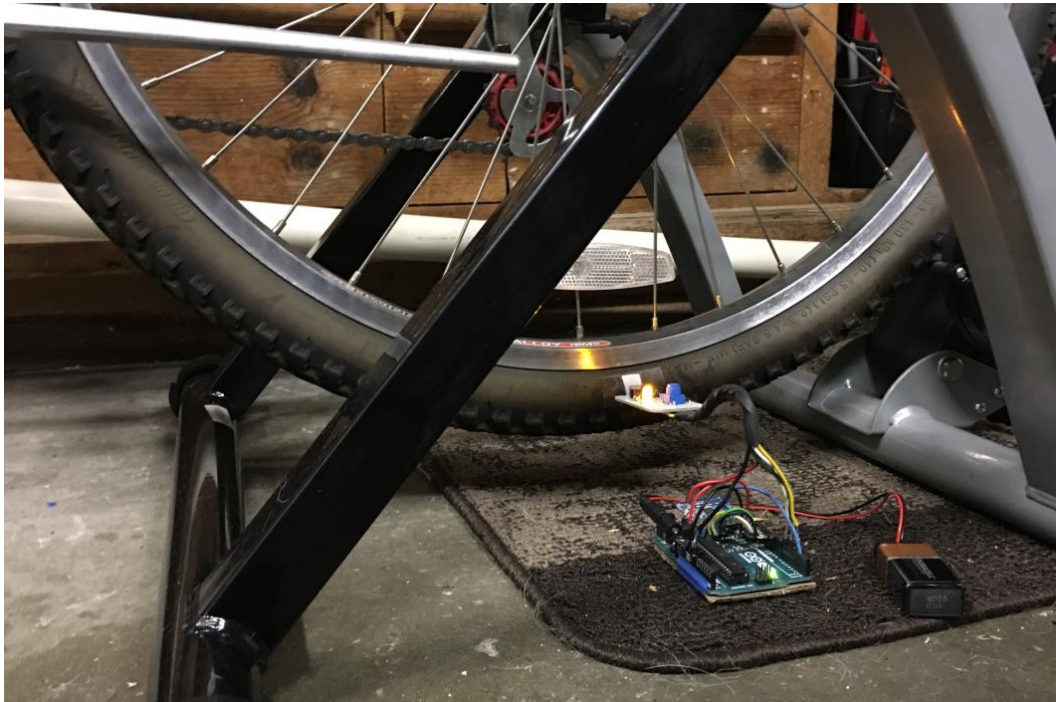
Ilustración 9: Placa de arduino con sensor infrarrojo colocada en la rueda
