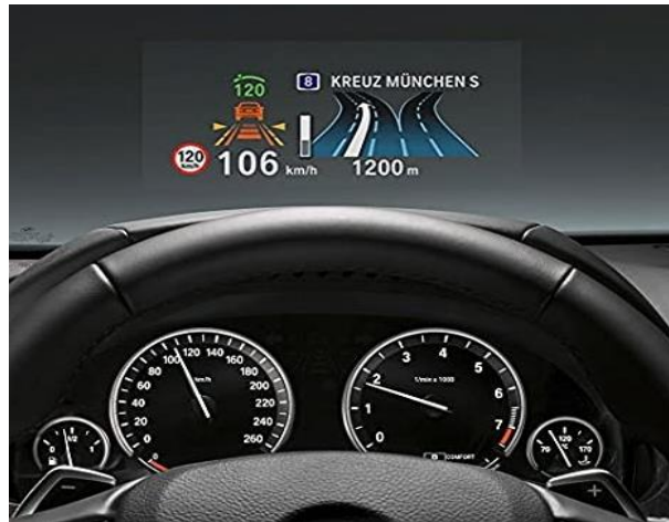
Ilustración 6. Tecnología HUD (Head Up Display) basada en proyección. (Fuente: portal web Xataka).
