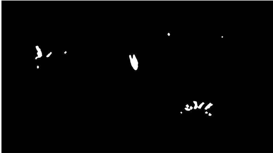
Figura 50. Efecto de operación de apertura sobre imagen umbralizada.
