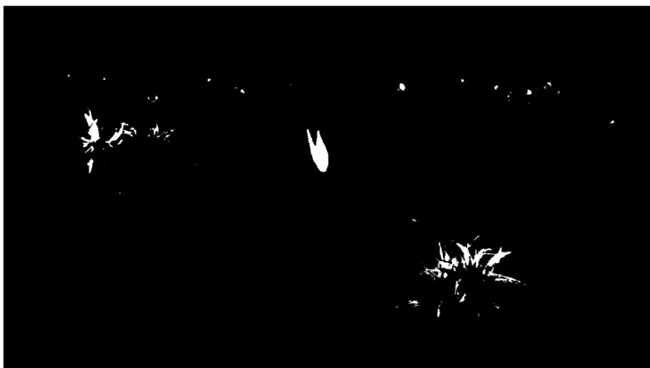
Figura 47. Efecto de filtro de la media de tamaño 3x3 sobre umbralización.
