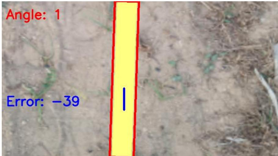
Figura 29. Detección de línea en entorno simulado con textura de suelo.
