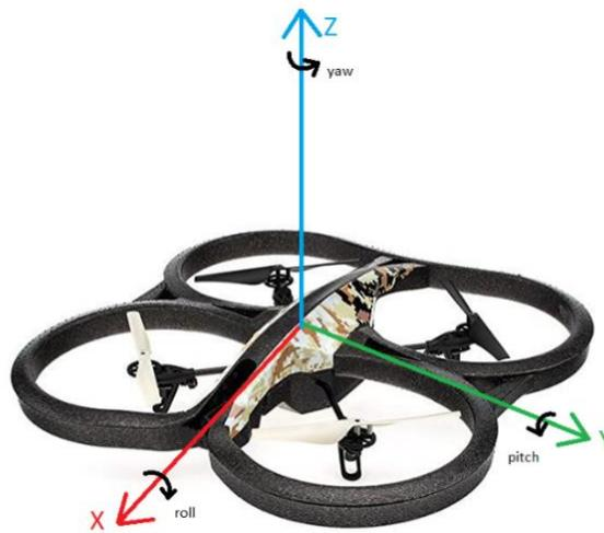
Figura 8. Ejes de referencia del drone con ángulos de giro indicados.
