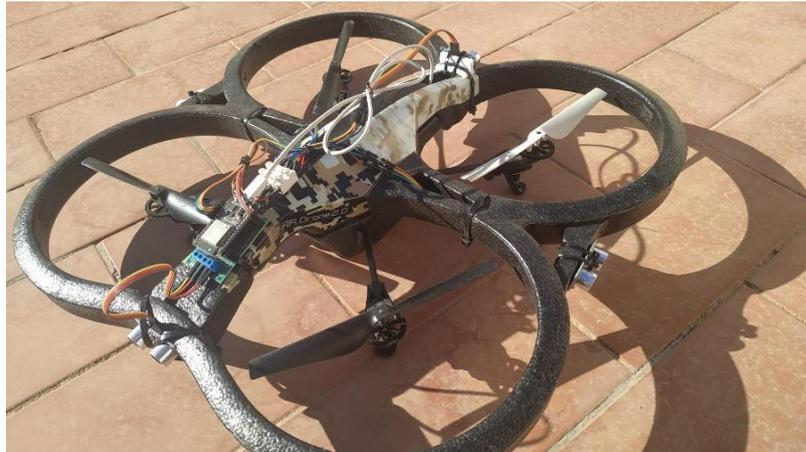
Figura 13. Montaje de sensores y placa ESP32 sobre drone real.
