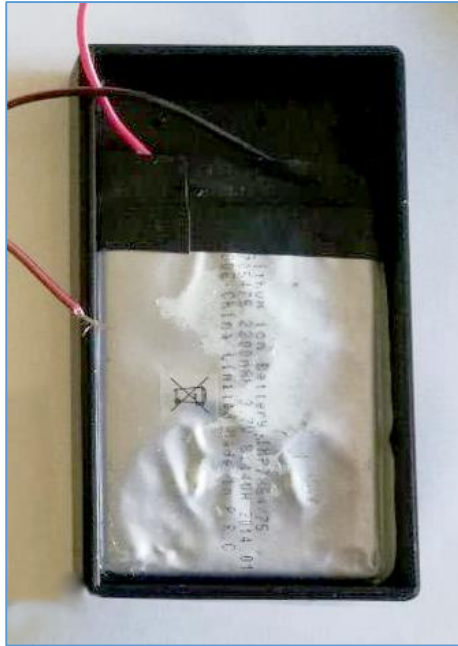
Ilustración 39: Introducción del sistema de almacenamiento en el cuerpo central del prototipo.
