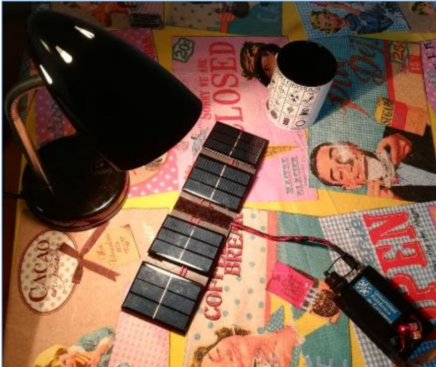
Ilustración 47: Prueba de carga con iluminación en interiores.
