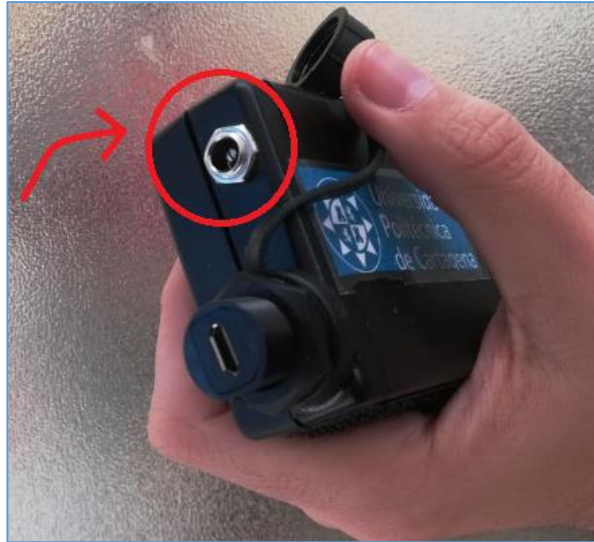
Ilustración 44: Vista del puerto de alimentación al cual se conectan los diferentes paneles.
