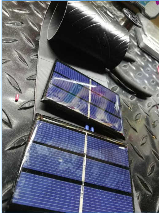
Ilustración 36: Paneles ya interconectados antes de ser fijados al material base.
