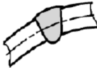
Figura 20. Soldadura para cerramiento de una misma virola.
