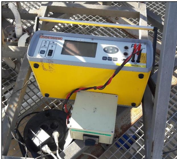
Ilustración 3.6.7 – Conexión PVPM-Caja de conexiones.
