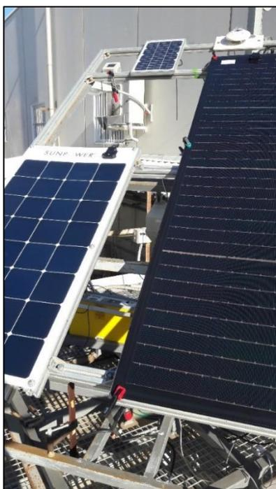
**Ilustración 3.6.4 – Módulos en el soporte con 34º de inclinación**
