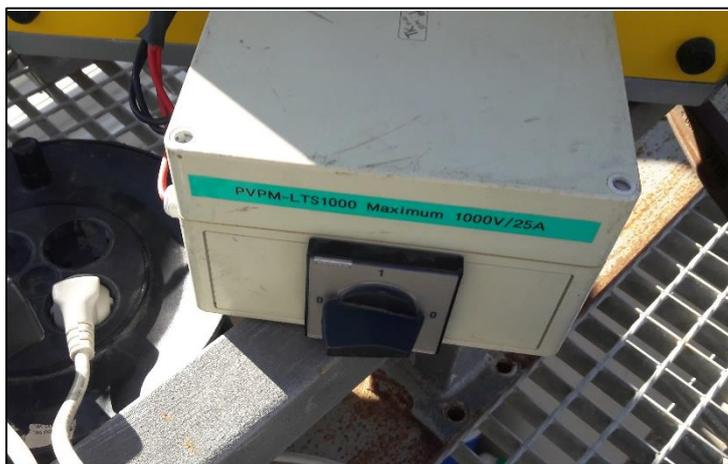
**Ilustración 3.6.6** – Interruptor externo de seguridad.
