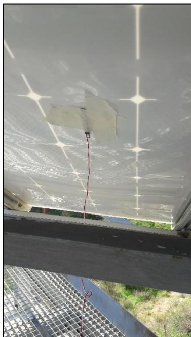
**Ilustración 3.6.10** – Conexión del sensor de temperatura (módulo 1)
