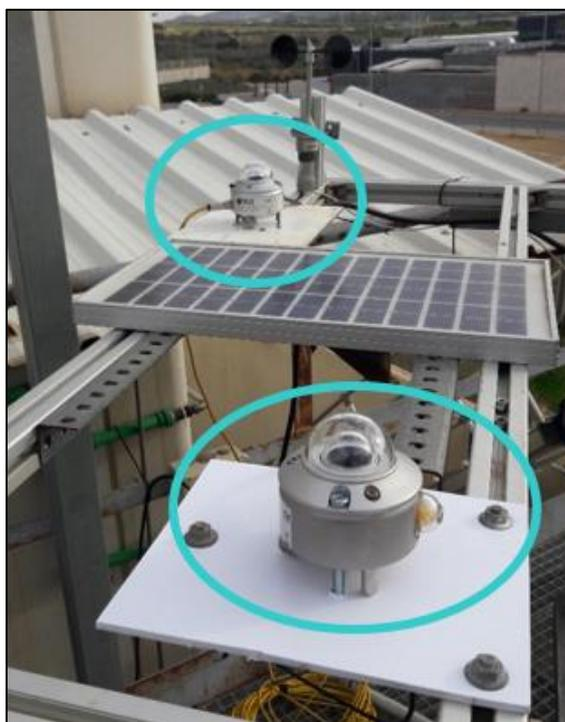
**Ilustración 5.2.2.1– Piranómetros instalados.**
