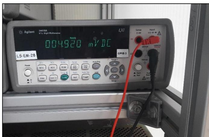
**Ilustración 3.5.3.1** - Multímetro midiendo tensión de piranómetro.
