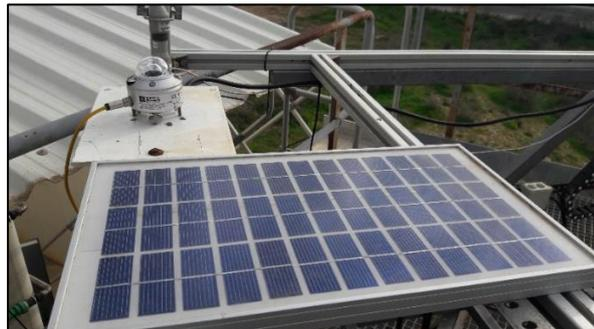
**Ilustración 5.3.4.3** – Placa y piranómetro de referencia instalados.
