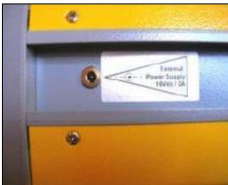
**Ilustración 3.6.3 – Carga de la batería en el lado izquierdo del trazador**
