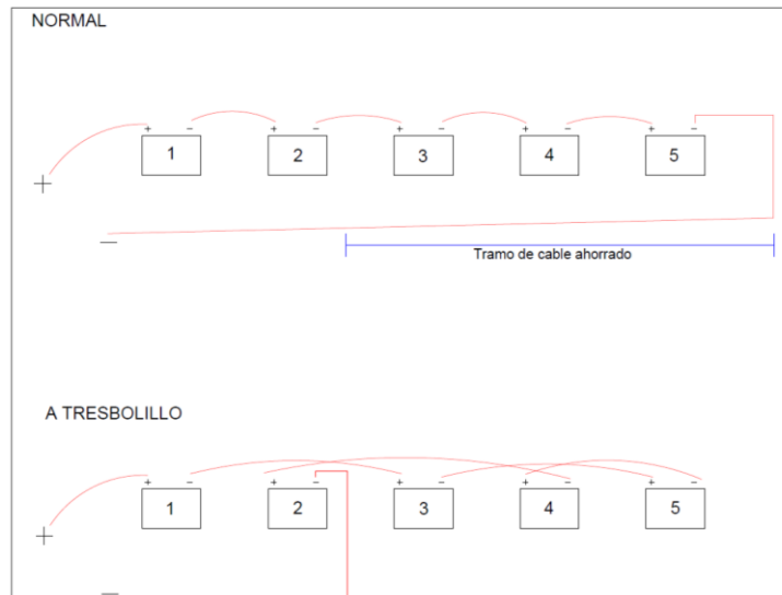
Figura 7.10: Conexionado clásico y a tresbolillo
