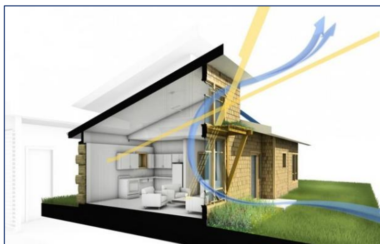
Fig. 2.2.3. Ventilación natural forzada
