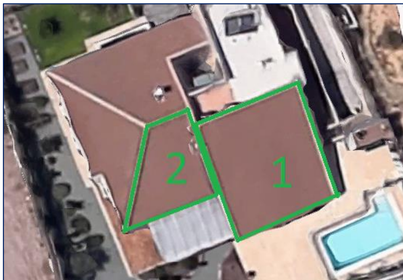
Fig. 5.1.3. Cubiertas elegidas para la ubicación de módulos solares
