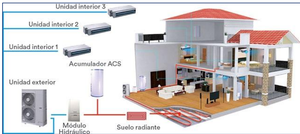
Fig. 1.3.4. Instalación de aerotermia para vivienda unifamiliar
