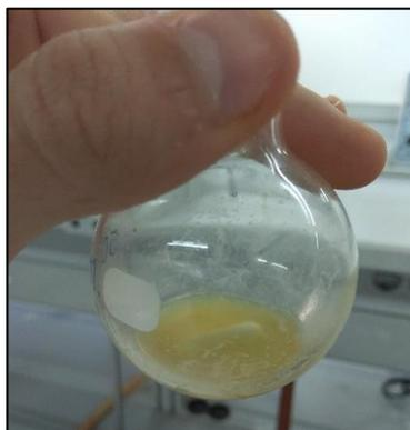
Figura 3.11. Precipitado amarillo de  $[\text{Pd}(\text{bipy})\text{Br}(\text{succ})]$ .
