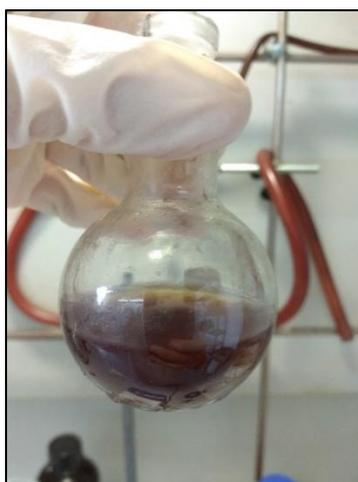
Figura 3.3. Precipitado marrón formado en la preparación de  $\text{Pd}_2(\text{dba})_3$ .
