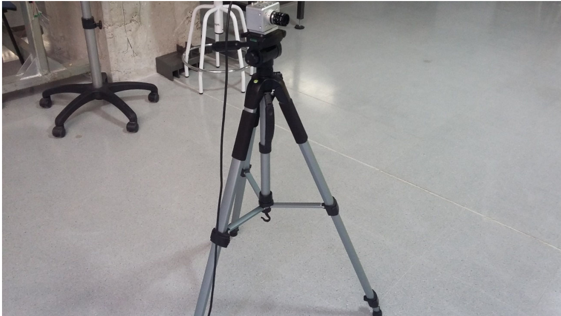
Fig. 5.6. Situación de cámara - videoextensómetro
