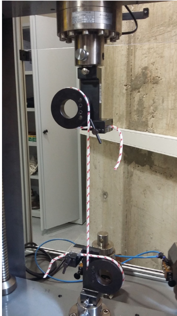
Fig. 5.5. Colocación de probeta en máquina de ensayo.
