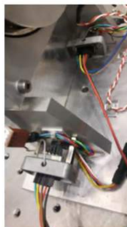
Figura 79.- En esta imagen se muestra la salida del conector DSUB de cada prisma del ADC. El cable, rojo y marrón corresponden al final de carrera. El resto de cables corresponden al motor.
