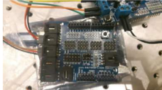
Figura 77.- A la izquierda se puede ver la placa Arduino Sensor Shield. A la derecha, cuando se han realizado las debidas conexiones provenientes de los finales de carrera.
