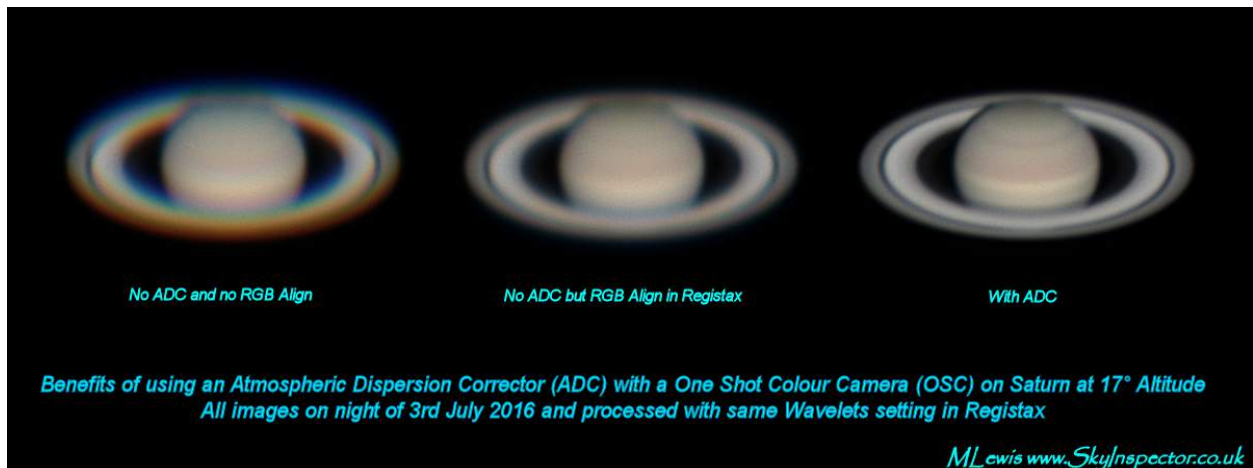
Figura 3.-Ejemplo de defecto de Dispersión Cromática Atmosférica sobre Saturno y su corrección con ADC
