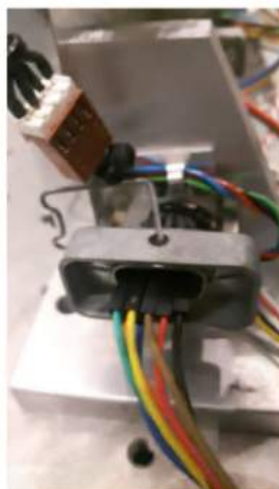
Figura 79.- En esta imagen se muestra la salida del conector DSUB de cada prisma del ADC. El cable, rojo y marrón corresponden al final de carrera. El resto de cables corresponden al motor.
