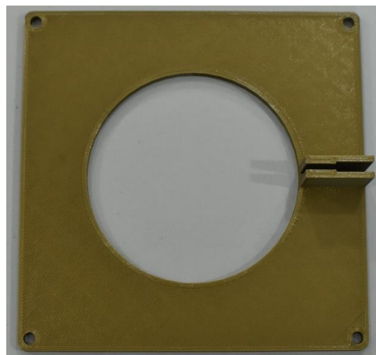
Figura 3.9: Brida con soporte para sensor
