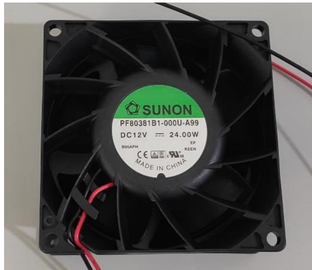
Figura 3.10: Ventilador con caudal volumétrico regulable
