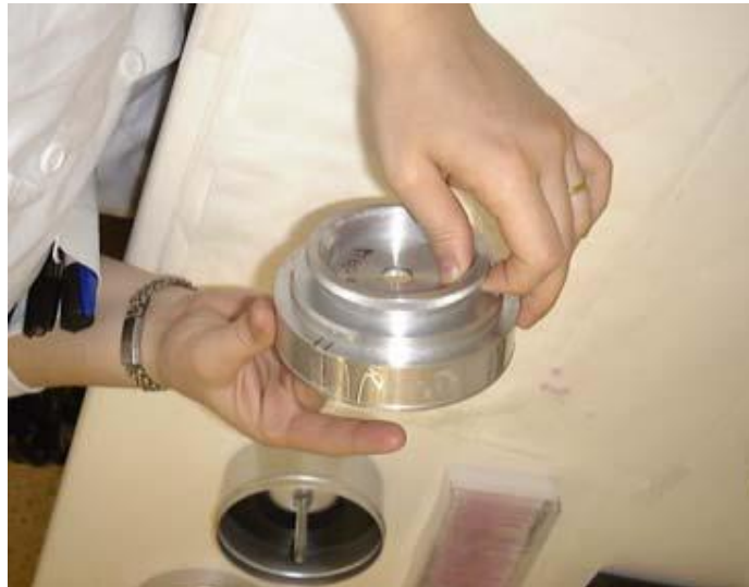
Figura 7. Separación de la cinta de Melinex del tambor.
