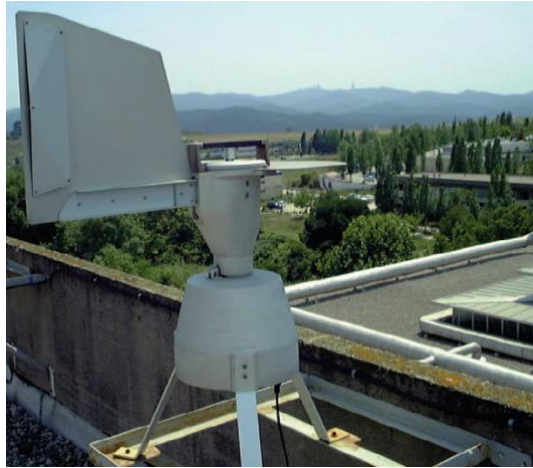
Figura 6. Captador tipo Hirst, dispositivo de muestreo utilizado para este estudio (Belmonte & Roure Nolla, 2002)
