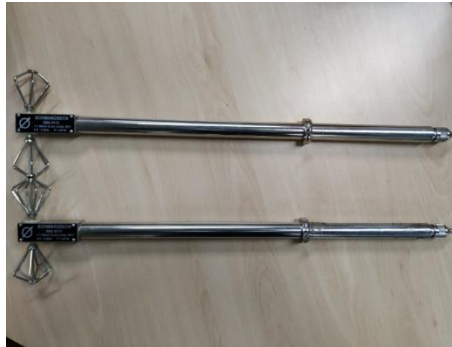
Figura 9 Antenas Bicónicas, modelo SCHWARZBECK SBA 9113. [SCHW9113]
