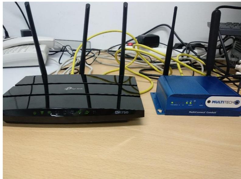
Figura 3.5: Gateway conectado al Router.
