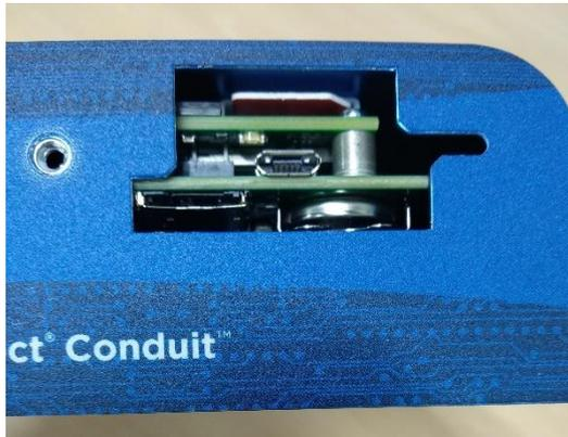
Figura 3.3: Tarjeta SIM del Gateway
