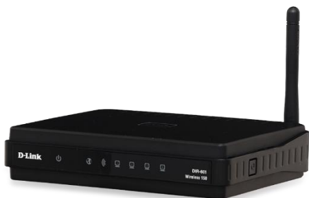
Figura 2.1: Ejemplo de WAP con antena omnidireccional
