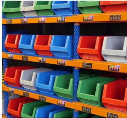
FIGURE 13- EJEMPLO DE SISTEMA PICK CON BOTONERAS Y PANTALLAS LCD.
