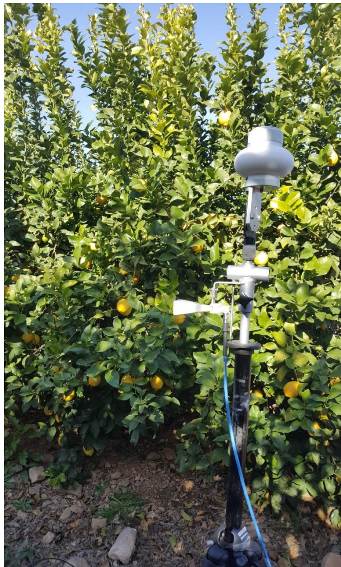
Figura 17. Antena Omnidireccional y Bocina conectadas
