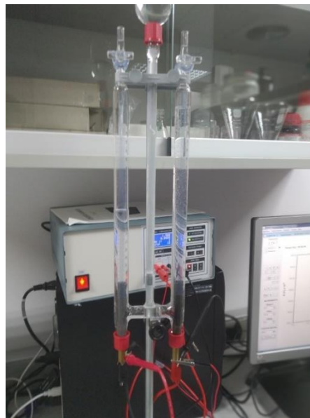
Imágenes 8 y 9. Ensayo 1 durante la electrólisis del agua (8) y al final de éste (9).
