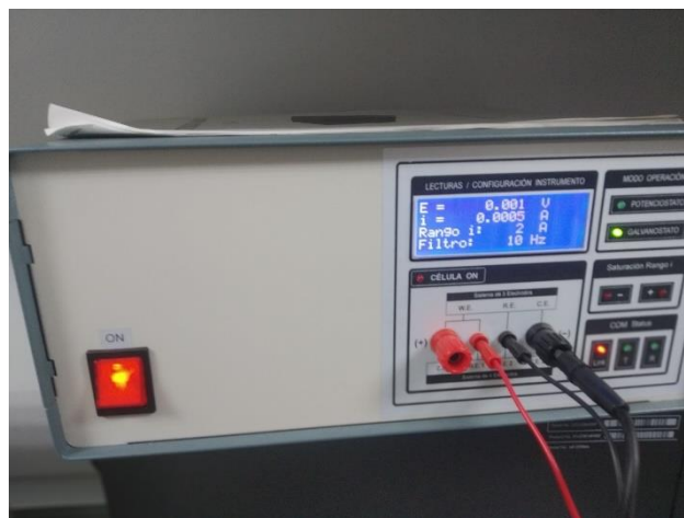
Imagen 5. Galvanostato utilizado en los ensayos de electrólisis del agua.
