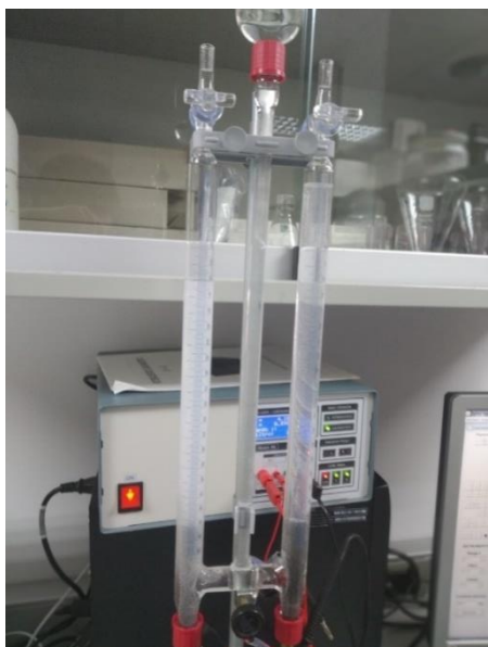
Imágenes 8 y 9. Ensayo 1 durante la electrólisis del agua (8) y al final de éste (9).
