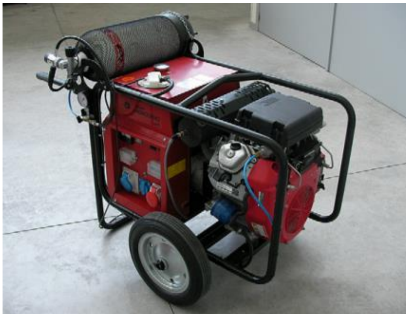
Imagen12. Grupo electrónico (Honda GX620) después de la modificación.
