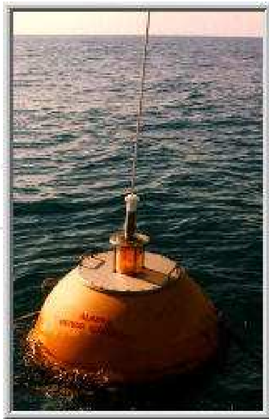
Figura 2.1: Foto de una boya Waverider.
