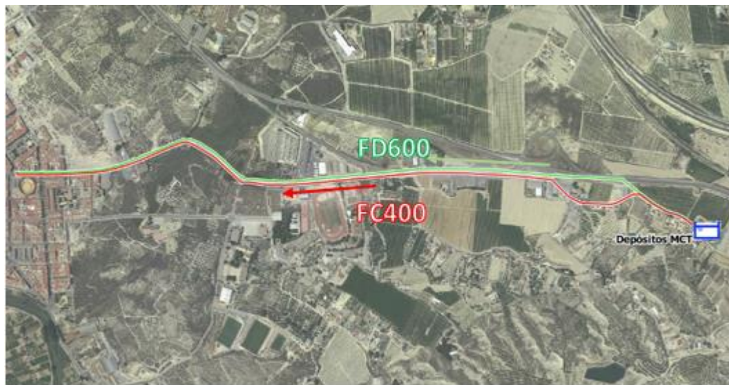
Figura 2.9: Conducciones de transporte desde los depósitos de la MCT. (Plan director abastecimiento Cieza)
