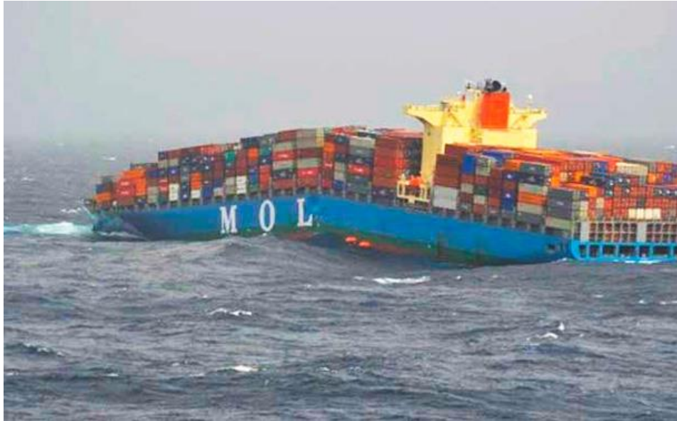
Figura 5.2 - Imagen de un buque sometido a esfuerzos de arrufo. 27
