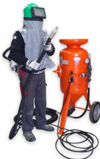
Figura 34. Trabajador del puesto 2: Preparación y decapado de la superficie del tanque
