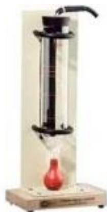
Figura 37. Medidor de caudal de burbuja
