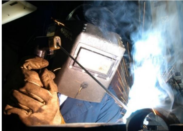
Figura 20. Soldadura por arco
