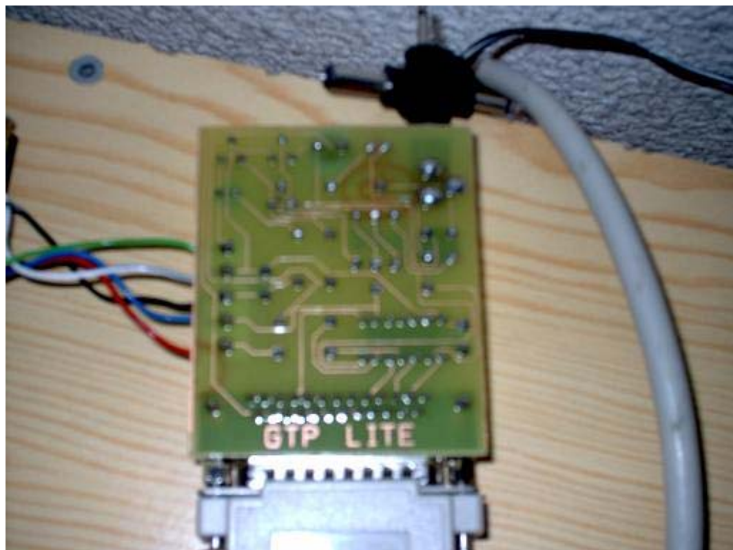
Fig. 2.45 Placa terminada. Vista Inferior
