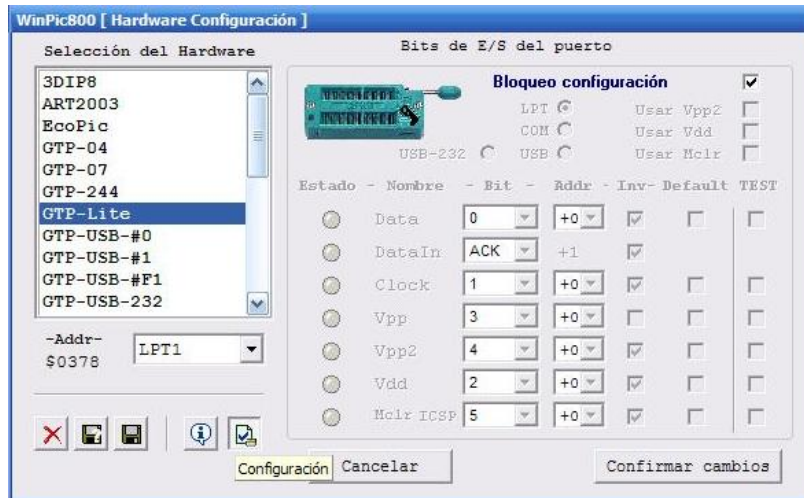
Fig. 2.34 Ventana de configuración de Hardware
