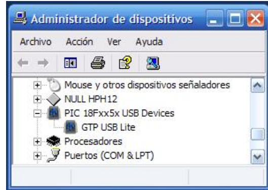
Fig. 2.50 GTP USB Lite instalado
