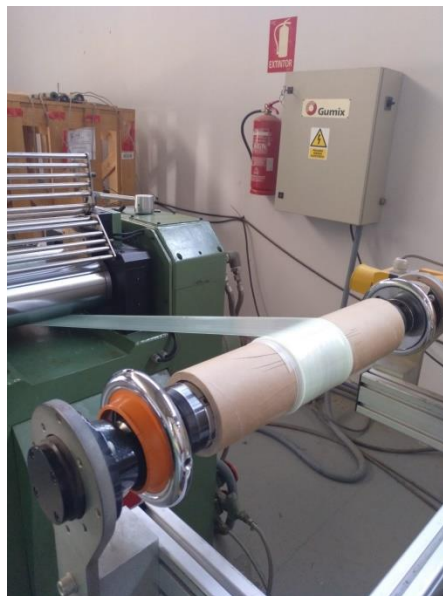
Imagen 23: Síntesis del film mediante la extrusora tipo TH E 20 25 L / D.
