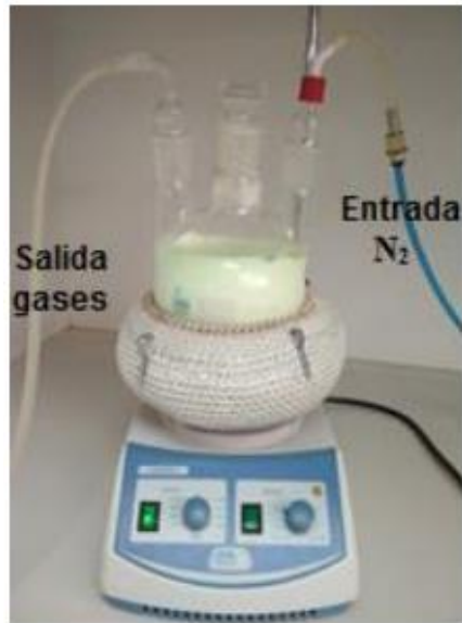
Imagen 19: Reactor donde se produce el intercambio iónico
