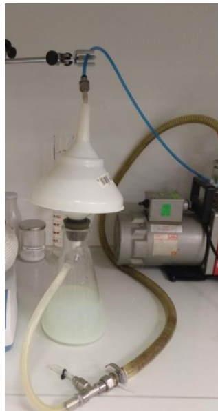
Imagen 20: Filtración mediante una bomba de vacío y atmósfera neutra
