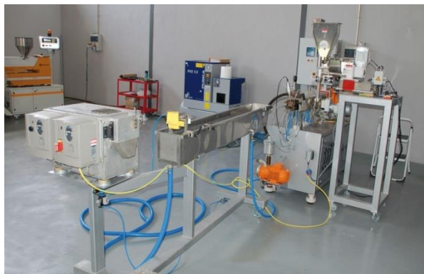
Imagen 17: Extrusora Leistritz, modelo ZSE 18HP
