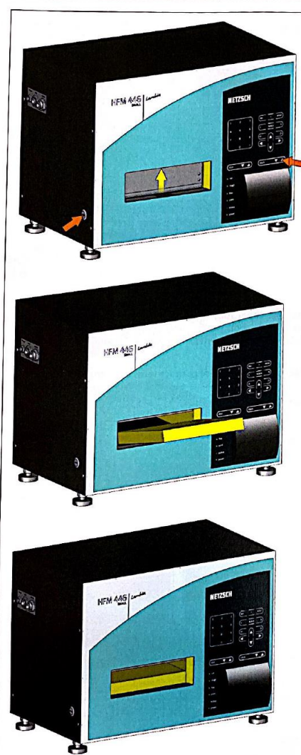
Figura 21 Segundo paso para insertar la muestra.
