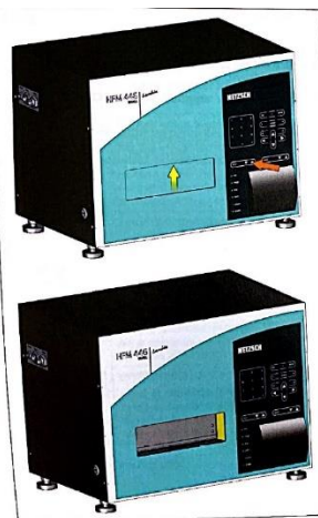
Figura 20 Primer paso para insertar la muestra.
