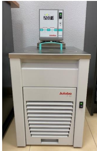
Figura 15 Sistema de refrigeración externo.
