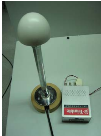
Figura 5.5: Oscilador de 10 MHz disciplinado por un GPS.
