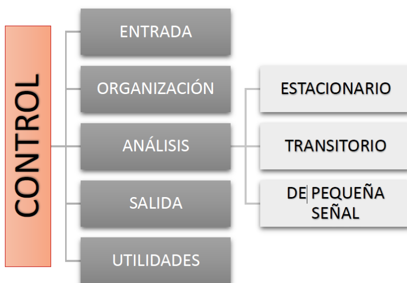
Figura 4.5 Diagrama de bloques del programa de simulación de circuitos NgSpice. Sánchez-Pérez (2012).
