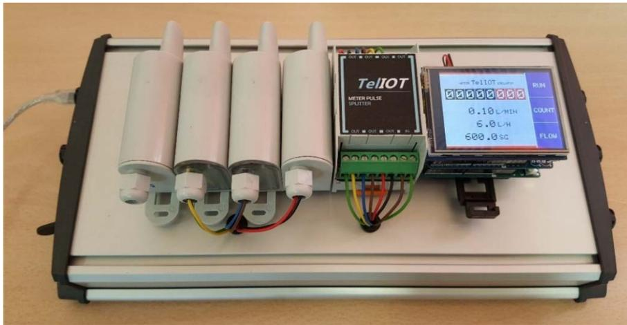
Figura 3.59. Consola para dispositivos IoT.
