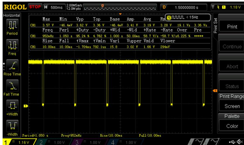
Figura 3.71. Tensión en extremos del relé de salida.
