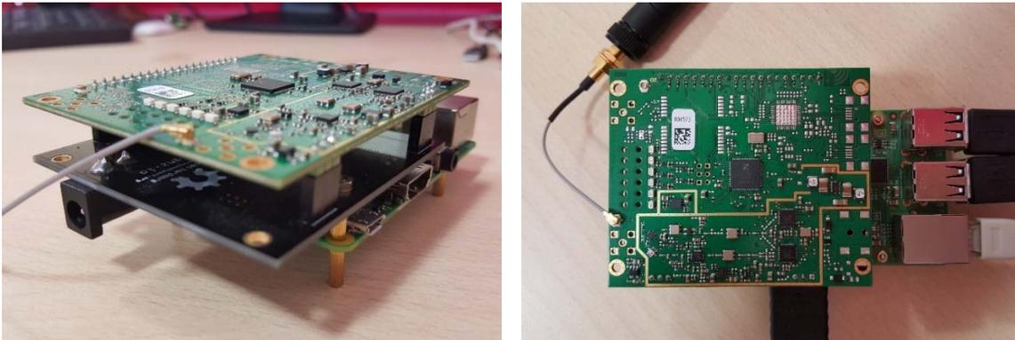
Figura 3.42. Vista del conjunto de placas y del conector de antena UFL del concentrador.
