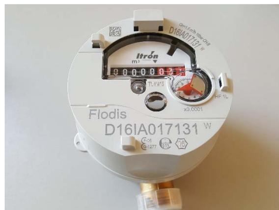
Figura 2.10. Contador Itron Flodis.
