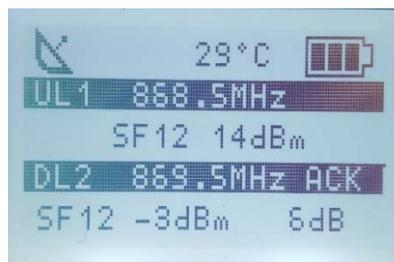
Figura 3.44. Pantalla del emulador de nodo LoRa tras enviar la trama.
