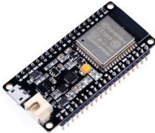
Ilustración 24. Microcontrolador Bluetooth y WiFi ESP32 de Expressif Systems.
