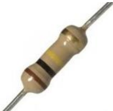
Ilustración 17. Resistencia de 100 \text{ k}\Omega y un 1/8 \text{ W} . Fuente: Google.
