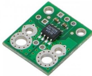
Ilustración 14. Sensor de corriente AC/DC ACS714 Efecto Hall de Pololu. Fuente: Electan
