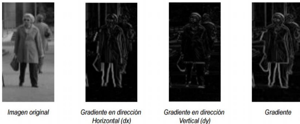
Figura 2.5 Gradiente en dirección horizontal y vertical de una imagen
