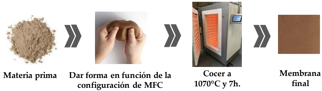
Figura 4.2 Proceso de fabricación de las membranas cerámicas.
