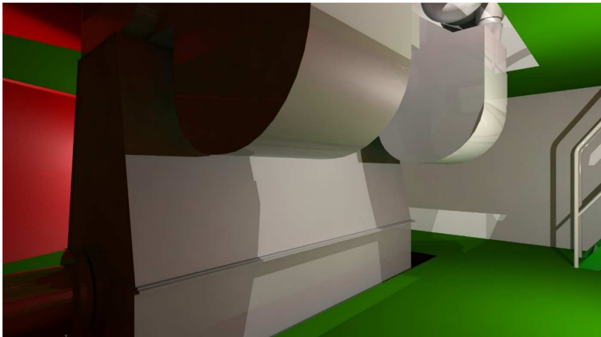
Ilustración 58 Vista del motor propulsor en doble fondo.
