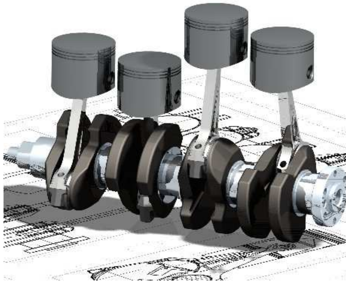
Ilustración 24 Imagen de cigüeñal realizado por NX Unigraphics
