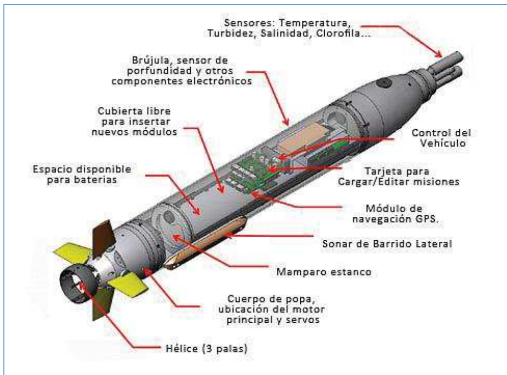
Imagen 30: Plano esquemático del AUV (Fuente: Unidad de Tecnología Marina, CSIC)
