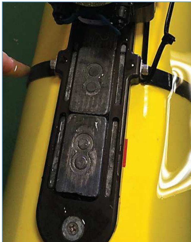
Imagen 53. 16 onzas de plomo en el raíl del vehículo
