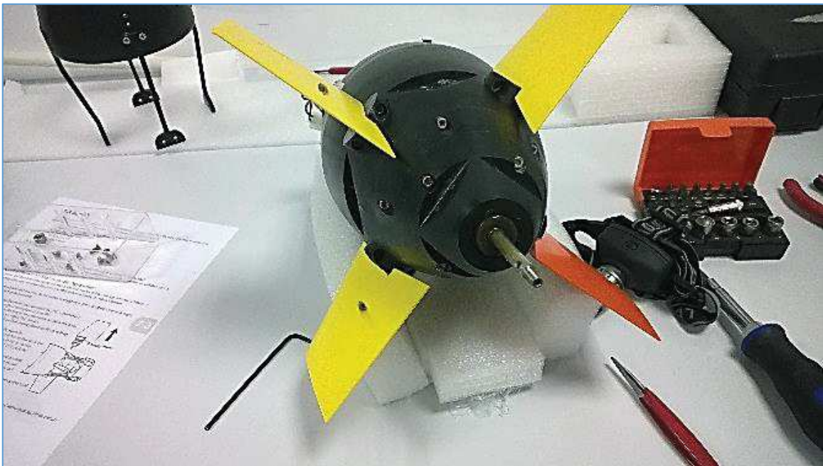
Imagen 39. Cuerpo de popa, con hélice y tobera desmontadas.
