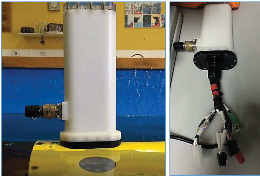
Imagen 49. Antena con la conexión para carga de baterías.
