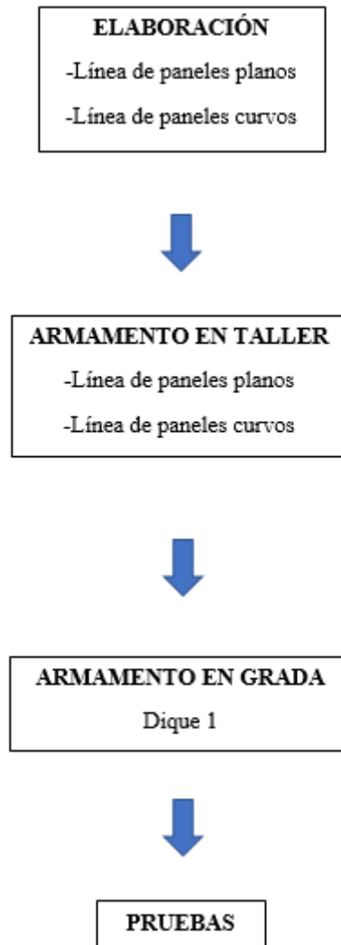
Figura 61. Fases del proceso constructivo
