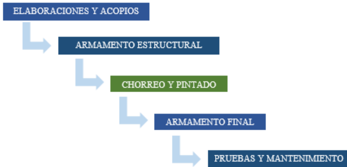
Figura 49. Fases generales de la construcción modular integrada
