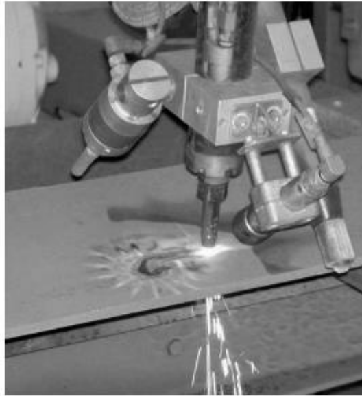
Figura 11. Equipos de soldadura de planchas
