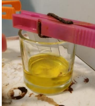
Ilustración 18. Eliminación de parte del ITO por la evaporación de mezcla ácida.
