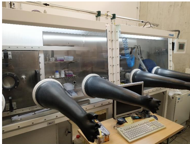
Ilustración 34. Caja de guantes edificio CAID, Universidad de Murcia.
