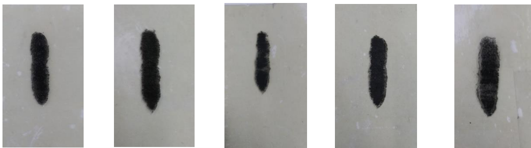
Figura 28 Progresión de izquierda a derecha (con contenido de carbón creciente) de la Serie 2 realizada por Screen-Printing sobre PET-ITO.
