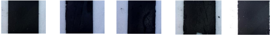
Figura 48 Progresión de izquierda a derecha de la Serie 5 (con contenido en carbón creciente) tras el secado sobre cristal de ITO.
