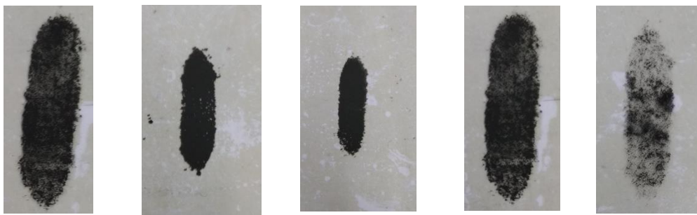
Figura 42 Progresión de izquierda a derecha (con contenido en carbón creciente) de la Serie 3 realizada con la Screen-Printing sobre PET-ITO.
