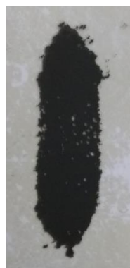
Figura 55 Tinta comercial depositada sobre PET-ITO mediante la técnica de Screen Printing.
