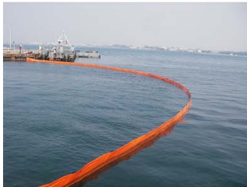
Figura 47: Barrera de cerco[29]
