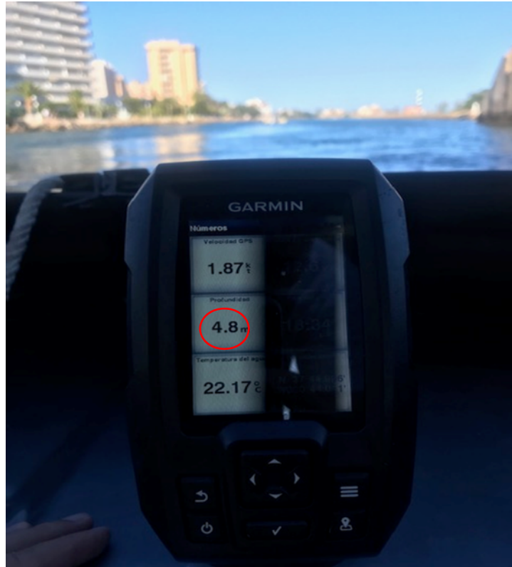
Figura 9: Sondeo de profundidad en la sección del proyecto.
