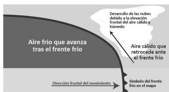
Figura 19. Esquema de desplazamiento de un frente frío. (CK-12 Foundation. Christopher Auyeung. https://dr282zn36sxxg.cloudfront.net/datastreams/f-d%3A05de8791822721116edf43caa146fb2b653c50d1bec40a0645515520%2BIMAGE%2BIMAGE.1 ).
