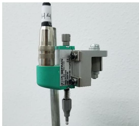
Figura 30. Transductor potenciométrico de 10 mm
