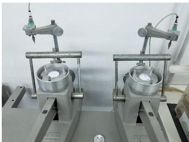
Figura 40. Muestras en la célula edométrica antes de ser reemplazadas
