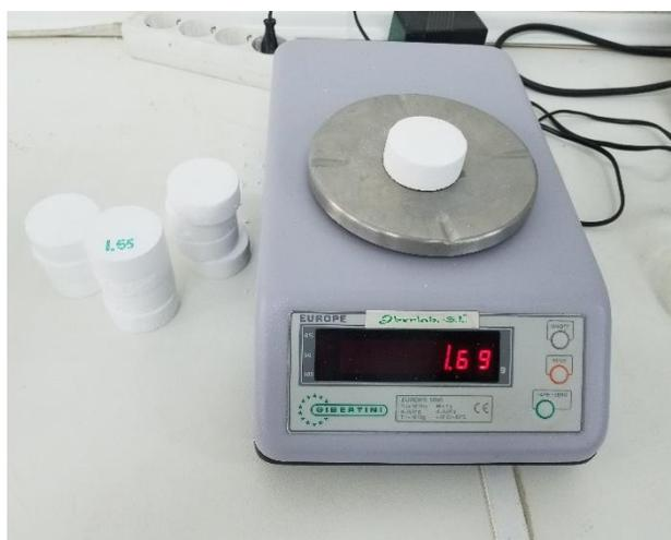
Figura 36. Durante el pesaje de las muestras cilíndricas
