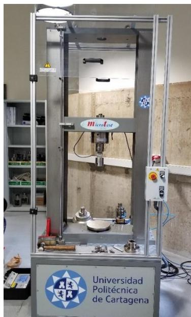
Figura 33. Máquina multiensayo Microtest EM2
