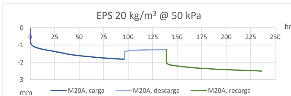
Figura 52. Comportamiento corregido del EPS 20 kg/m<sup>3</sup> a 50 kPa (kPa)
