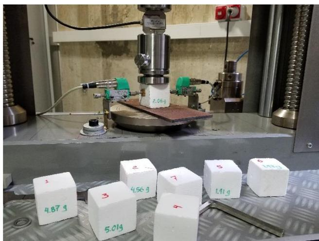
Figura 60. Las ocho muestras cúbicas ensayadas a compresión simple
