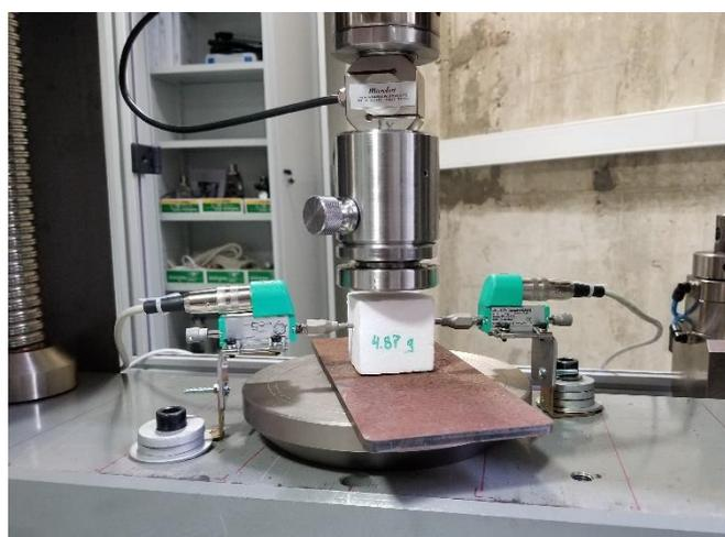
Figura 39. Adaptaciones para ensayar las muestras cúbicas de EPS
