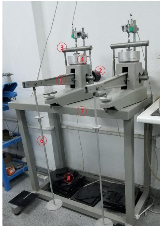
Figura 29. Edómetros del laboratorio de geotecnia de la UPCT
