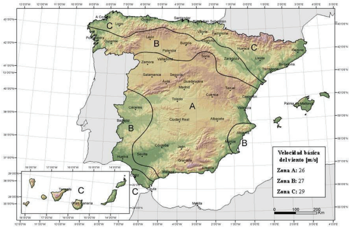
Figura 10 Valor básico de la velocidad del viento, v_b (Figura D.1 CTE DB SE-AE)
