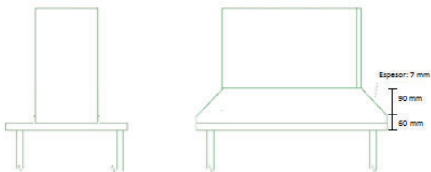
Figura 28 detalle de la placa de anclaje
