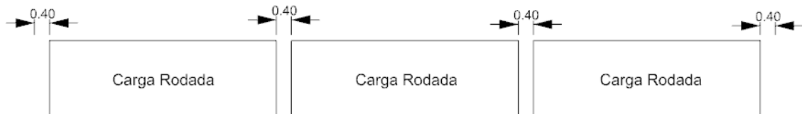
Figura 2.1. Esquema de la distribución en eslora de la carga rodada.
