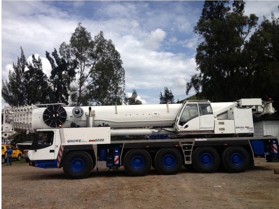
Figura 10: Camión grúa del tipo GROVE GMK5220
