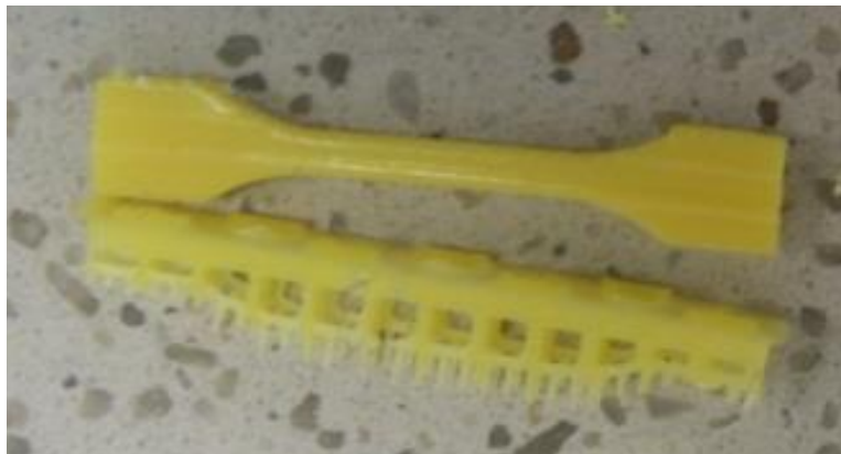
Figura 76. Limpieza de los soportes de la impresión Horizontal-transversal
