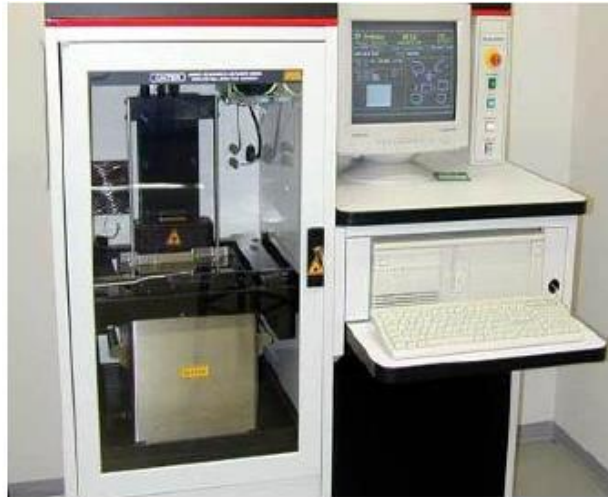
Figura 26. Modelo de una impresora que utiliza STL. Modelo Industrial informatizado.
