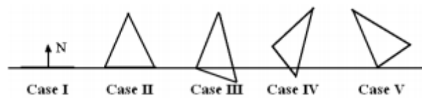
Figura 4. Diferentes casos del plano de corte. La superficie es paralela a la base, no es necesario calcular la intersección de los puntos (Caso I). La superficie toca el plano de corte con sus dos vértices y estos dos puntos son las ubicaciones de la intersección (Caso II). Uno de los vértices toca el plano de corte. La otra intersección se calcula utilizando una ecuación lineal (Caso III). Ninguna de los vértices del triángulo toca el plano de corte, pero uno de los vértices está al otro lado del plano (Caso IV). La superficie toca el plano en un solo punto el cual es redundante para el resto del código (Caso V).
