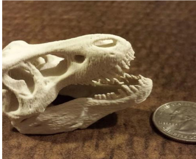
Figura 50. Ejemplo de impresión con Laybrick
