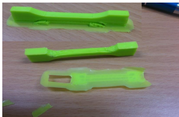
Figura 74. Muestra realizada mediante la impresión FDM
