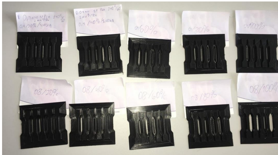
Figura 80. Muestras R04 y R08 para diferentes grados de relleno
