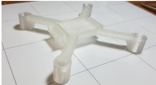
Figura 53. Ejemplo de objeto realizado con Bendlay con aspecto brillante
