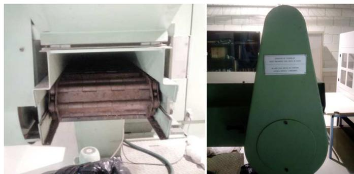
Figura 3-16: Salida del extractor de viruta
