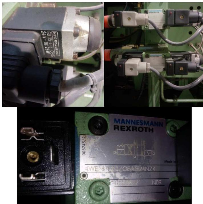
Figura 3-22: Electroválvulas seccionadoras
