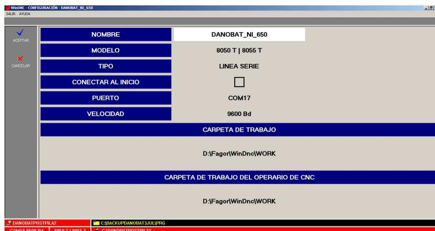
Figura 3-36: Configuración WINDNC
