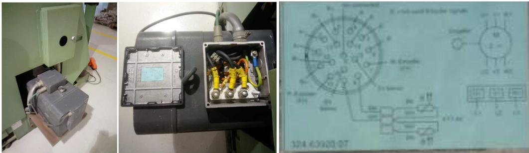
Figura 3-5: Motor principal. Caja de conexiones y esquema de conexiones del encoder
