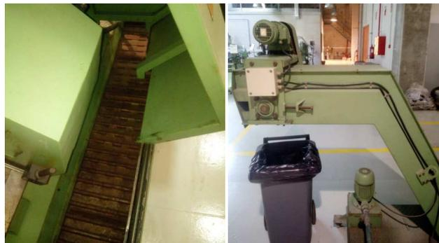
Figura 3-15: Cinta en la cámara de mecanizado y brazo de extracción
