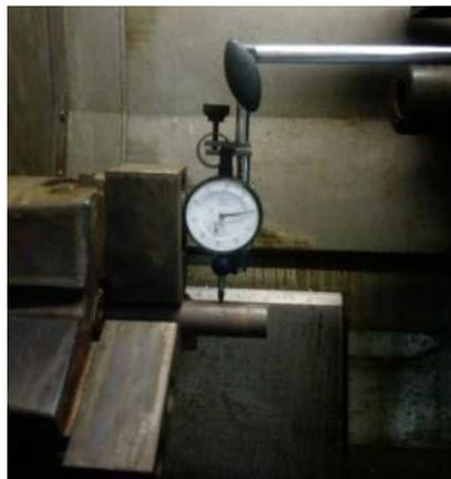
Figura 4-4: Medida de descentrado con reloj comparador
