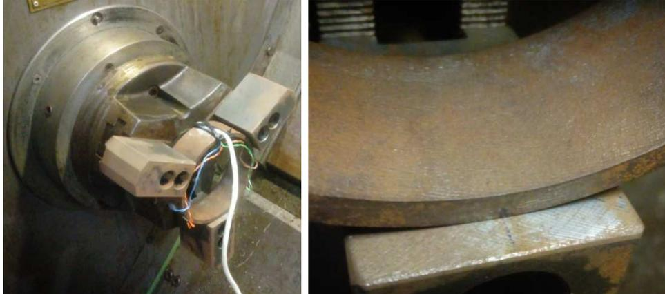
Figura 6-24: Anillo sobre el plato de garras y comprobación de posición
