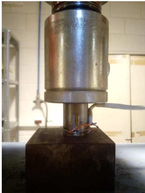
Figura 6-21: Disposición de la probeta en prensa
