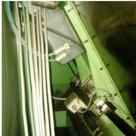
Figura 3-10: Interior de la máquina. Servomotor eje X y final de carrera de eje Z
