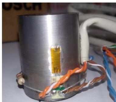
Figura 6-14: Instalación de galgas sobre probeta para ensayos preliminares
