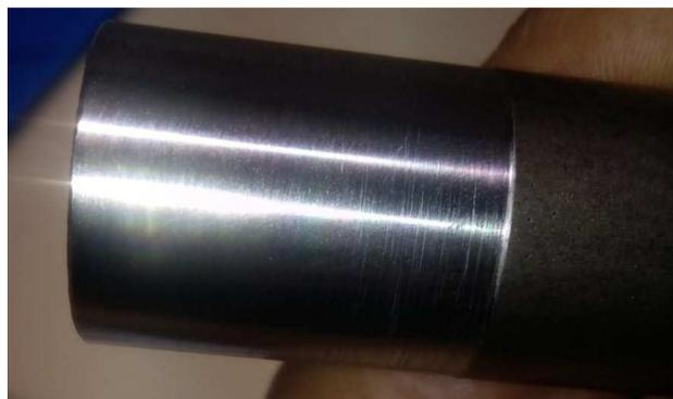
Figura 4-3: Probeta mecanizada
