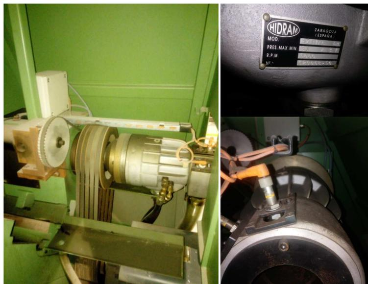
Figura 3-4: Cilindro: Correas de tracción, placa de características y sensores
