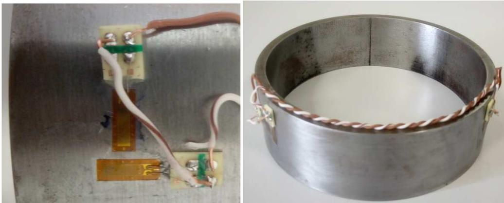
Figura 6-13: Instalación de galgas sobre anillo
