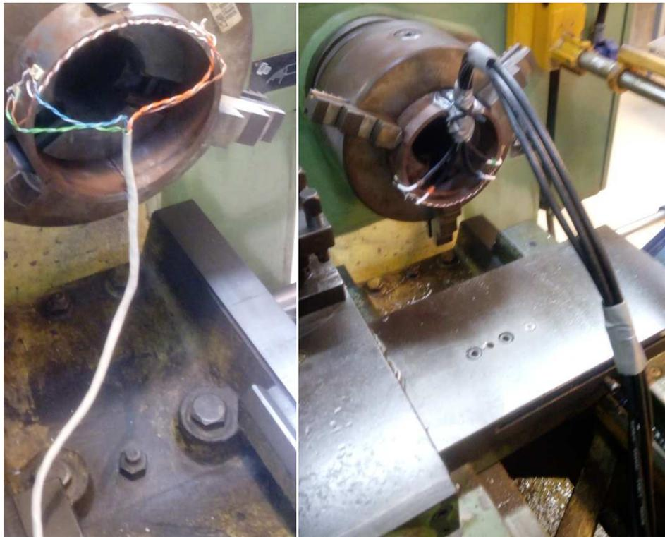
Figura 6-15: Cableado con puente sobre la pieza
