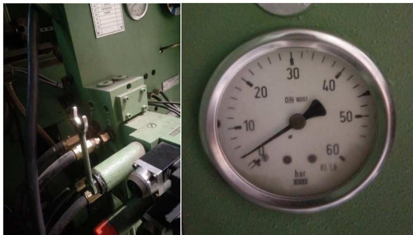
Figura 6-23: Regulación de presión de amarre a 4 bar
