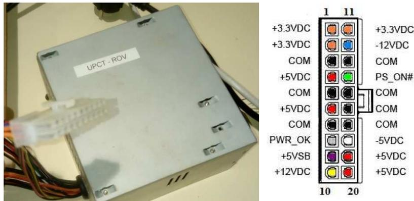
6-3: Fuente de alimentación y esquemático del conector
