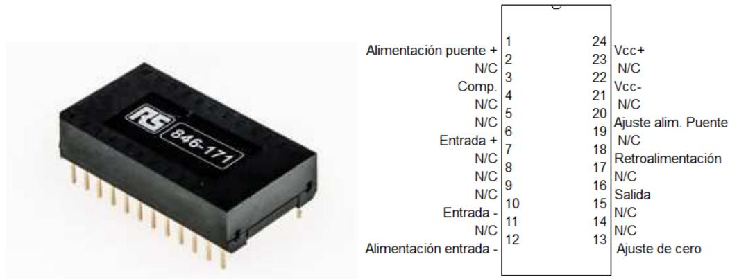
Figura 6-7: Amplificador de instrumentación RS 846-171
