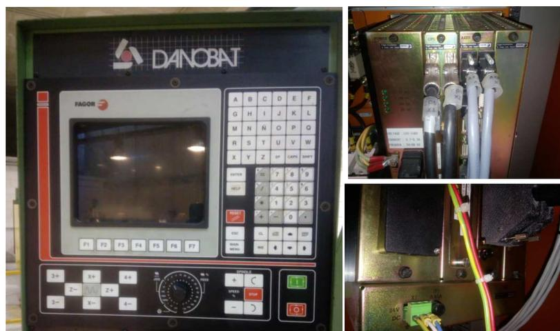
Figura 3-34: Control Fagor. Panel, módulos y ubicación de la batería
