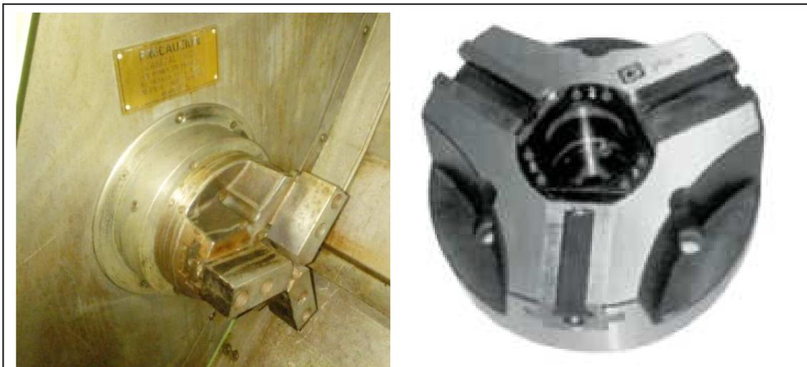
Figura 3-3: Plato HUSL 200 instalado y fotografía de catálogo
