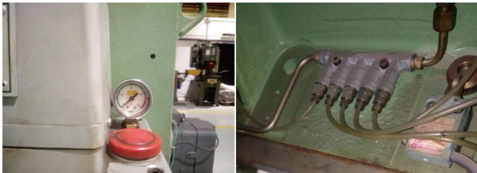
Figura 3-18: Presión de aceite y distribuidor
