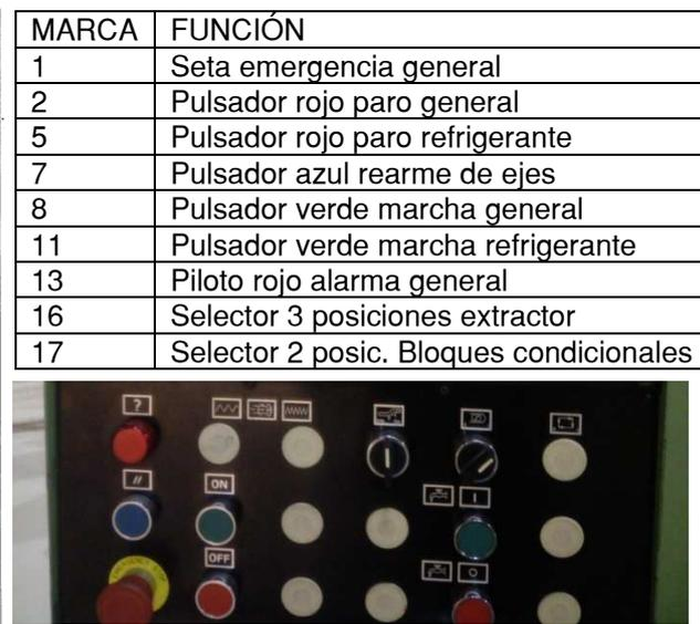
NOTA: La función de rearme de ejes tiene como objetivo la supresión de los finales de carrera del recorrido de los ejes, para su recolocación en caso de emergencia por salida de recorrido. Para activar esta función es necesario mantener presionado el pulsador mientras se da tensión en el interruptor general del portón central en la parte trasera de la máquina.
