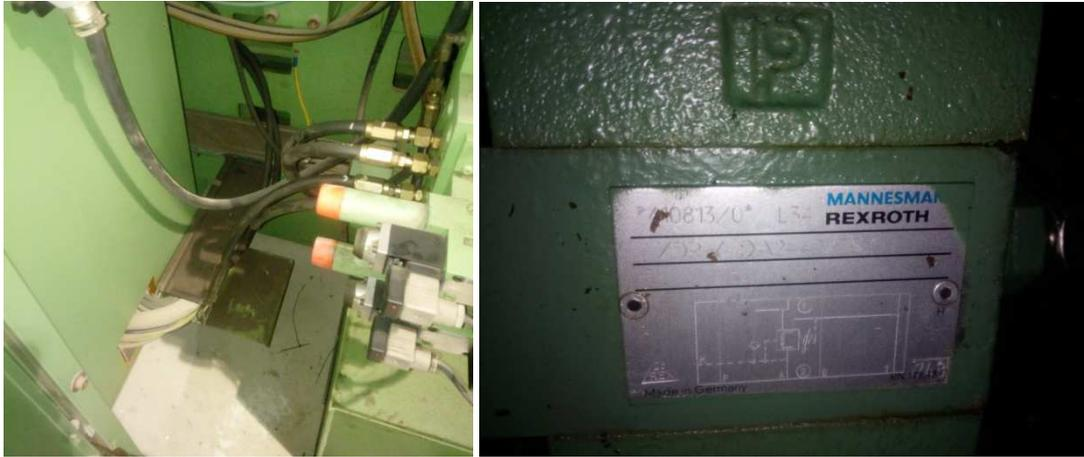
Figura 3-23: Válvulas reductoras
