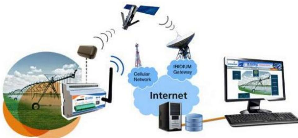
Figura 3 Ejemplo de las tres partes de un sistema de telemetría [7]
