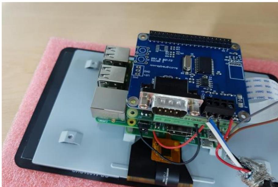
Figura 49 RASPBERRY PI3 CON EL ADAPTADOR PIKAN2
