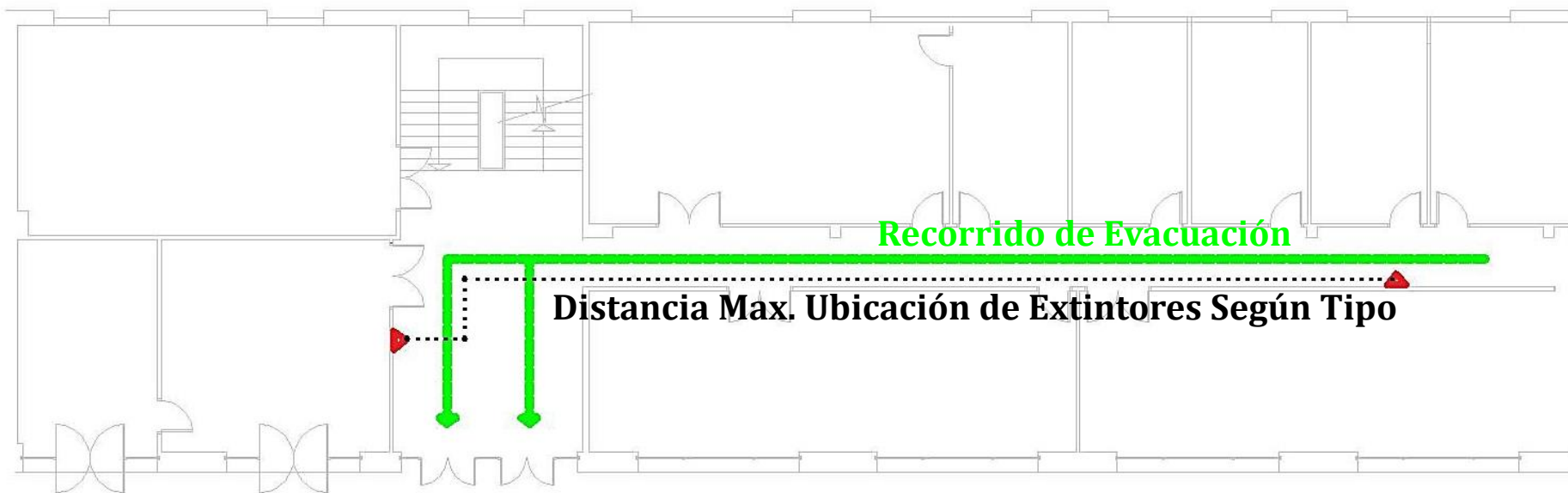
FIG. 23. ESQUEMA DE COLOCACIÓN DE EXTINTORES
