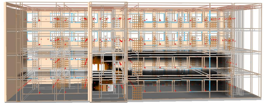
FIG. 45. SIMULACIÓN DE INCENDIO EN EDIFICIO DE OFICINAS. DESARROLLO DEL FUEGO LUEGO DE 34 SEGUNDOS DESDE SU INICIO.
