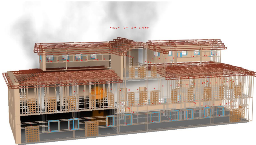
FIG. 44. SIMULACIÓN DE INCENDIO EN CASA RUBIO EL ALGAR. DESARROLLO DEL FUEGO LUEGO DE 27 SEGUNDOS DESDE SU INICIO.
